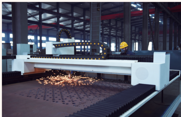
通化建新科技有限公司技术人员正在用20KW激光切割设备加工镍铁冶炼设备配套备件。司清华 摄
