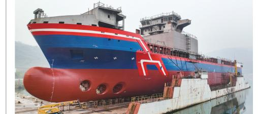
3月30日,这是在江西九江市瑞昌市下巢湖拍摄的万吨级远洋通信海缆铺设船"龙吟9 号"(无人机照片)。3月29日,万吨级远洋通信海缆铺设船"龙吟9号"在江西九江市瑞昌市 下水。该船全长155米,宽23.2米,一次性载缆量可达10000吨,可以一次性完成从中国跨越 太平洋的海底光缆铺设。该船在铺缆作业系统、新型吊放设备、全船电力推进等方面实现了 自主开发和国内建造。据介绍,该船正在进行舾装,预计今年9月交付使用
